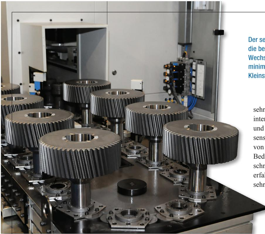
Der sehr einfach zu rüstende Lader der 300TWG wurde von Gleason an die bei ZaTeC verwendeten Werkstückhalter angepasst. Ein nahtloser Wechsel zwischen Hand- oder Kranbestückung und Laderautomation minimiert die unproduktiven Zeiten – auch bei rascher Abfolge von Kleinstlosen, Einzel- und Serienfertigung.
